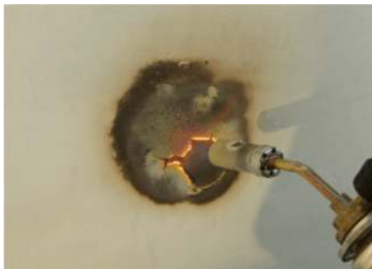
TLM Ceramic не поддерживает горение. Материал в пламени горелки обугливается без выделения токсичных веществ.
